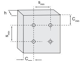
SHEAR LOADS - AFSHUIFBELASTING - CHARGE DE CISAILLEMENT <sup>1,2)</sup>
